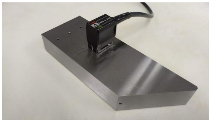
Рисунок 15 Установка АР на НО UCB 007
