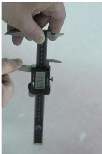
Рисунок 3 – Измерение толщины льда с помощью электронного штангенциркуля
