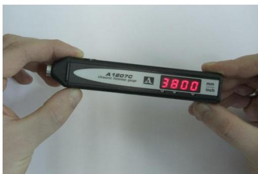
Рисунок 4 – Найденное значение скорости распространения ультразвука
