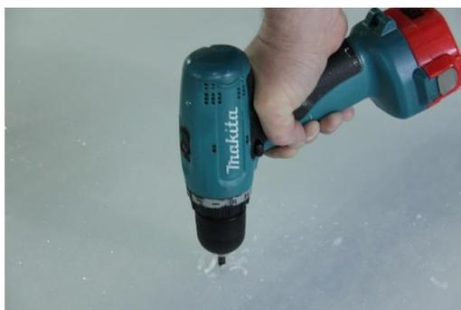
Рисунок 2 – Сверление льда для настройки и проверки толщиномера
