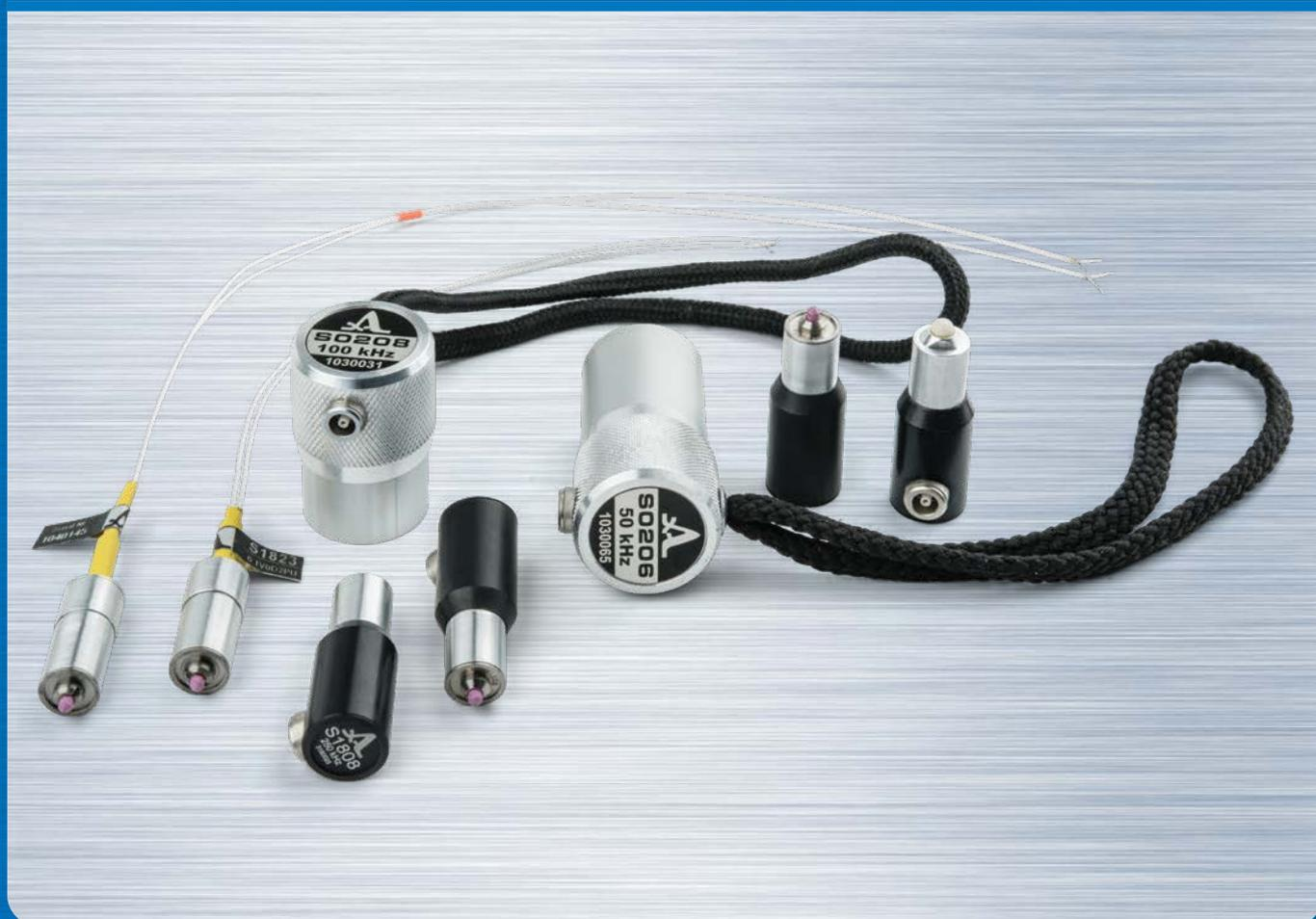
Низкочастотные преобразователи с точечным контактом предназначены для определения скорости и времени прохождения ультразвука, с целью оценки прочности, при поверхностном и сквозном прозвучивании объектов из бетона или железобетона. Преобразователи подключаются к электронному блоку низкочастотного дефектоскопа посредством одинарного кабеля LEMO. Контроль осуществляется с
