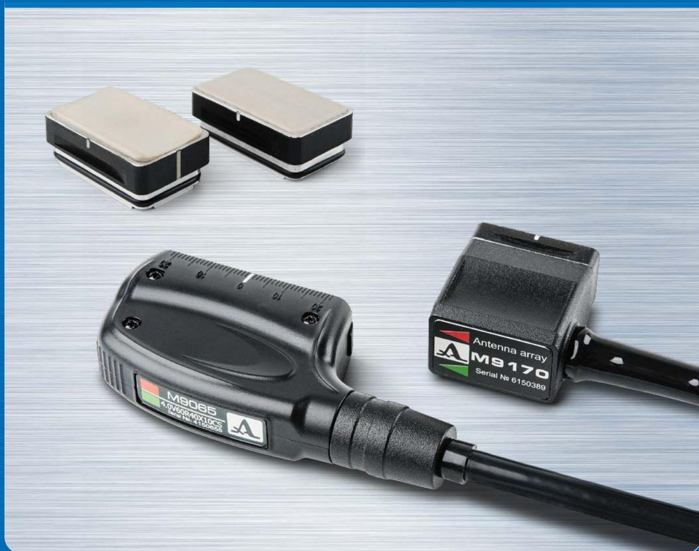
Многоэлементные антенные решетки предназначены для поиска дефектов в сварных швах и контроля основного тела металлических и пластиковых конструкций. Антенные решетки являются функционально-завершенным устройством, которое состоит из корпуса, встроенного кабеля с разъемом для подключения к высокочастотному дефектоскопу – томографу и сменного акустического модуля. В корпусе расположен коммутационный узел с разъемом для под-
