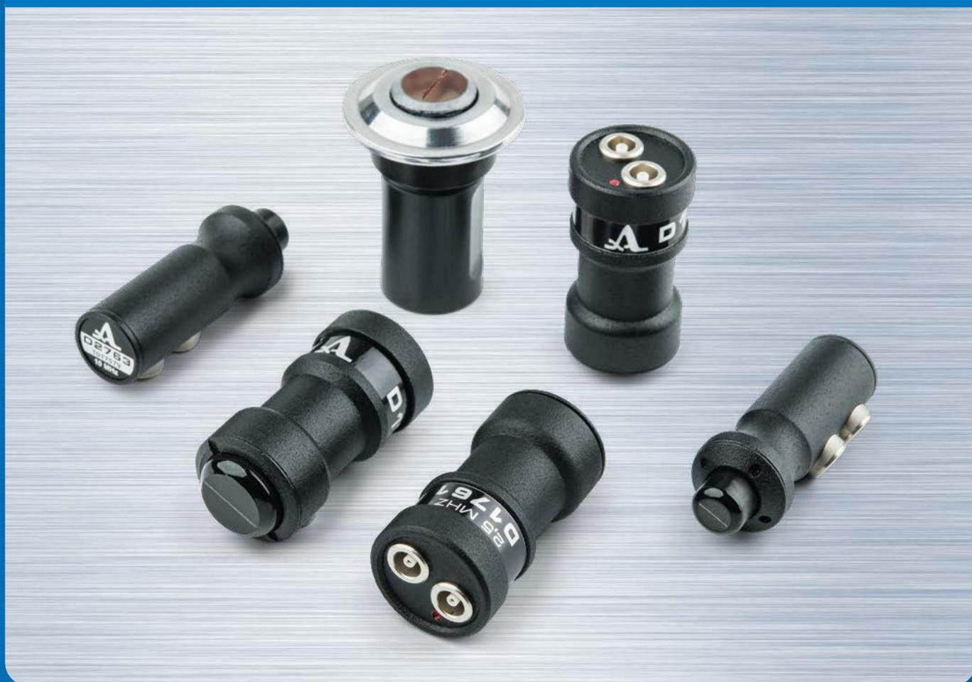
Раздельно-совмещенные преобразователи с жидкостным контактом предназначены для измерения толщины и поиска дефектов в различных изделиях из металлов и пластмасс (полиэтилен). Преобразователи подключаются к электронному блоку толщиномера или дефектоскопа посредством двойного кабеля LEMO. Благодаря наличию двух пьезоэлементов в конструкции, раздельно-совмещен-
