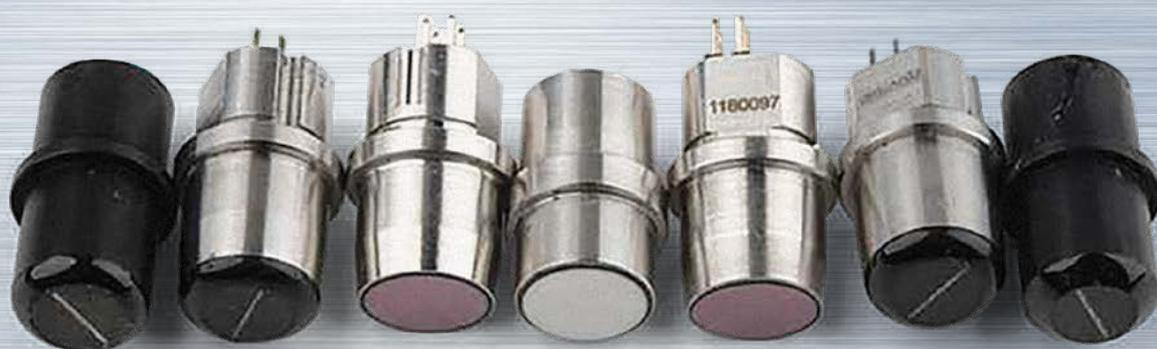
Съемные прямые пьезопреобразователи с жидкостным контактом для толщиномеров ультразвуковых А1207 и А1207U с малым пятном контакта и возможностью оперативной замены без дополнительных инструментов. Предназначены
