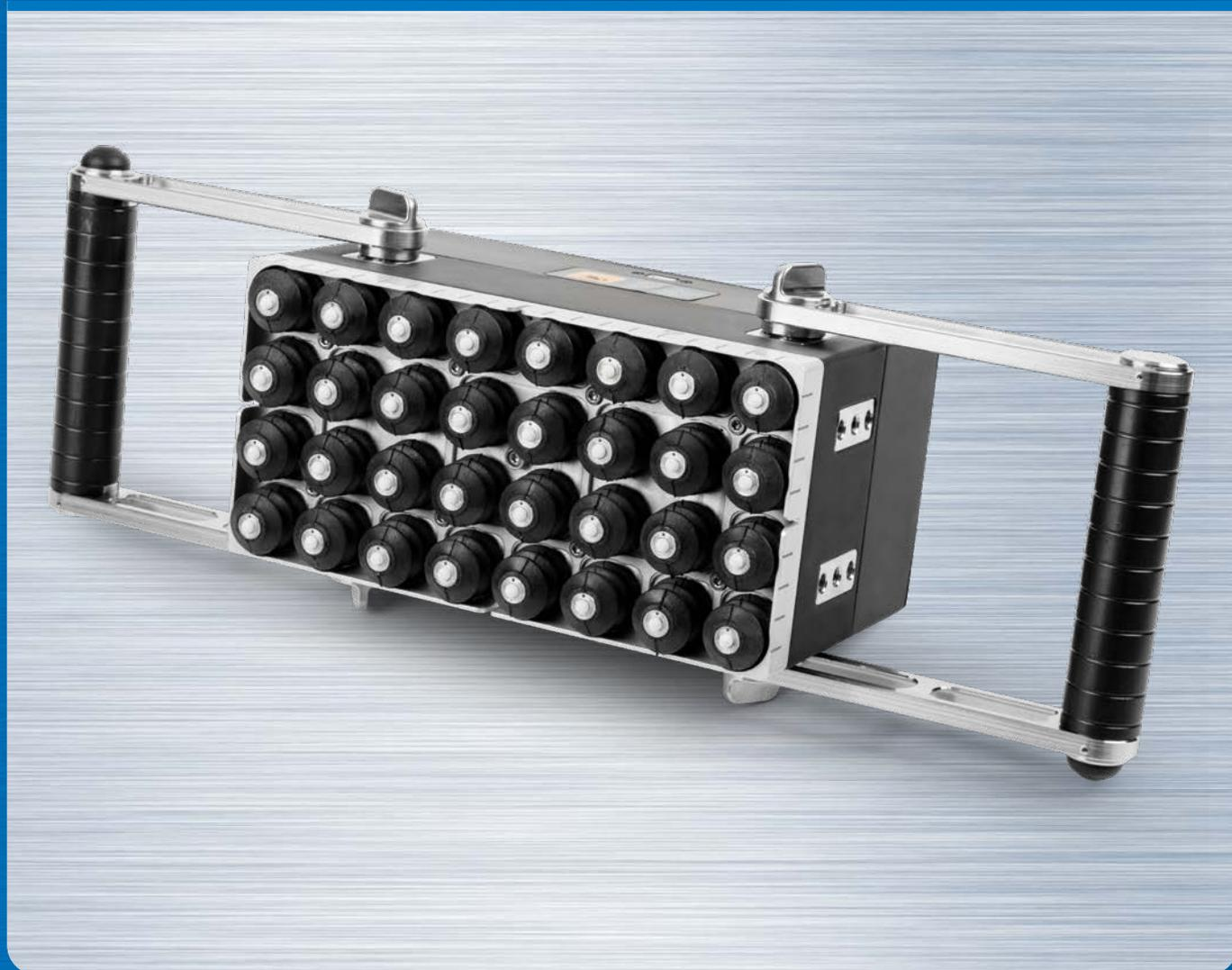
Низкочастотные антенные решетки с точечным контактом предназначены для поиска дефектов в конструкциях из бетона, железобетона и природного камня, а также для определения толщины объекта контроля при одностороннем доступе. Антенные решетки подключаются к электронному блоку низкочастотного дефектоскопа посредством одинарного и/или двойного кабеля LEMO. В зависимости от типа
