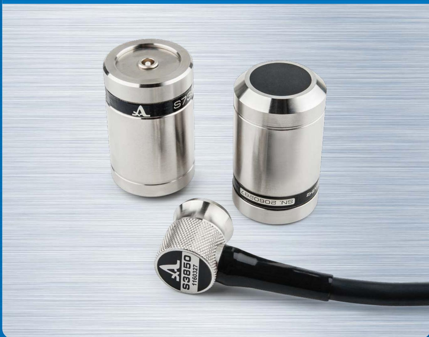
Электромагнитно-акустические преобразователи предназначены для измерения толщины металлоконструкций, труб, деталей и узлов из металлов и сплавов без применения контактной жидкости. Электромагнитно-акустические (ЭМА) преобразователи используют в составе с ультразвуковым ЭМА толщиномером А1270 для проведения толщинометрии. Преобразователи подключаются к электронному блоку толщиномера через переходник посредством одинарного кабеля LEMO (серия S73 и S76 – ЭМАП с постоянным магни-
